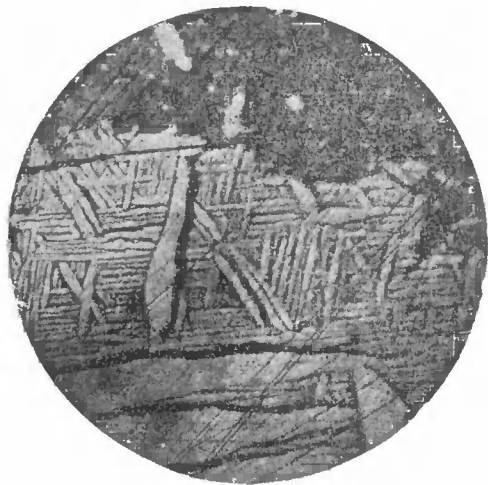
Решётчатая структура распада твёрдого раствора халькопирита и борнита с содержанием 90\% халькопирита. Светлое — халькопирит, тёмное — борнит. Микрофотография в масляной иммерсии при увеличении в 500 раз.
